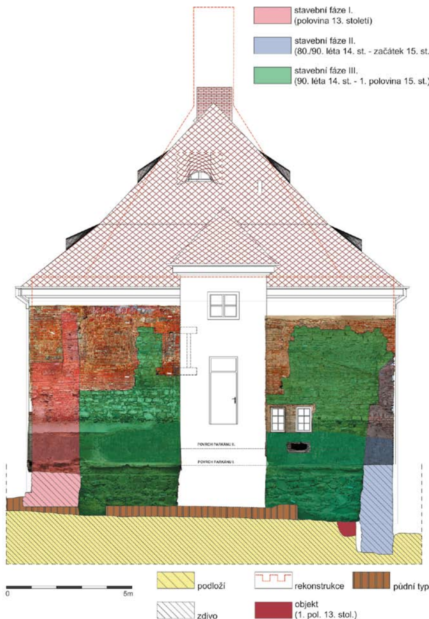
Obr. 28: Opava, Müllerův dům čp. 1, archeologický výzkum 2013, operativní průzkum a dokumentace 2016–2017. Jižní fasáda objektu s vyznačením hlavních nálezových situací z období středověku. Barevně vyznačeny dochované podpovrchové i nadzemní reliktu městské hlavní hradby z poloviny 13. století (transparentní červená; v řezu), městské parkánové hradby ze závěru 14. století (transparentní modrá; v řezu) a jižní obvodové zdi hradních kuchyní z přelomu 14. a 15. století až první poloviny 15. století (transparentní zelená). Červenou čárkovanou linií rekonstrukce možné podoby hradních kuchyní s dvojicí dymníkových komínů (zaměření fasády M. Struhala, fotogrammetrie R. Kadlubiec, úpravy a celkové zpracování F. Kolář, 2021).
