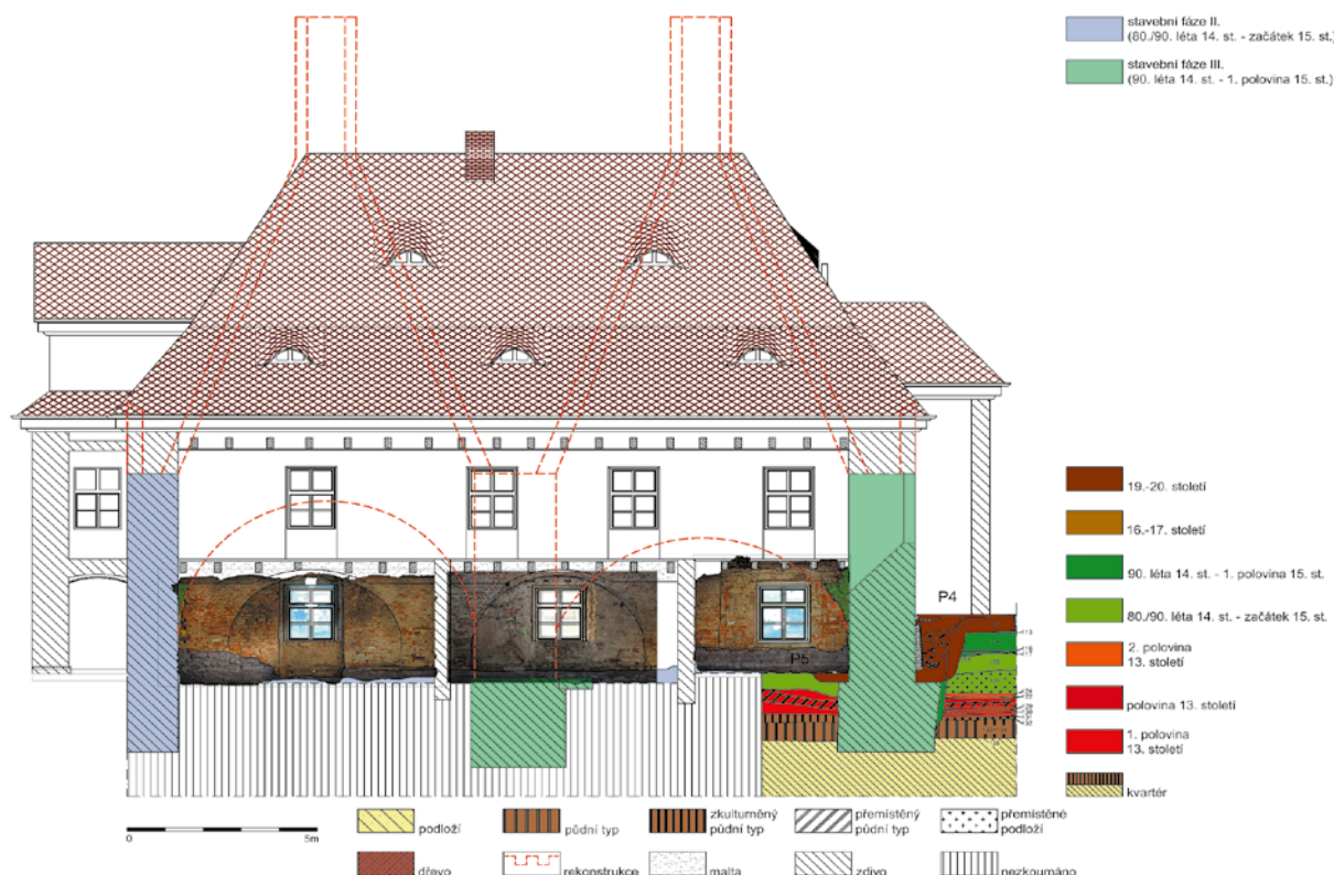
Obr. 36: Opava, Müllerův dům čp. 1, archeologický výzkum 2013, operativní průzkum a dokumentace 2016–2017. Podélný řez objektem s vyznačením hlavních nálezových situací z období středověku a dílčí barevné vyhodnocení řezu historickým nadložím (profily P4 a P5). Barevně vyznačeny dochované podpovrchové i nadzemní relikty spojovací hradby městského opevnění a hradu (v řezu) a městské parkánové hradby ze závěru 14. století (transparentní modrá), jižní obvodová zeď (v řezu) se základem pilíře dymníkových komínů a s výlevkou, a propust v parkánové hradbě z přelomu 14. a 15. století až první poloviny 15. století (transparentní zelená). Červenou čárkovanou linií rekonstrukce možné podoby hradních kuchyní s dvojicí dymníkových komínů (zaměření fasády M. Struhala, fotogrammetrie R. Kadlubiec, úpravy a celkové zpracování F. Kolář, 2021).
