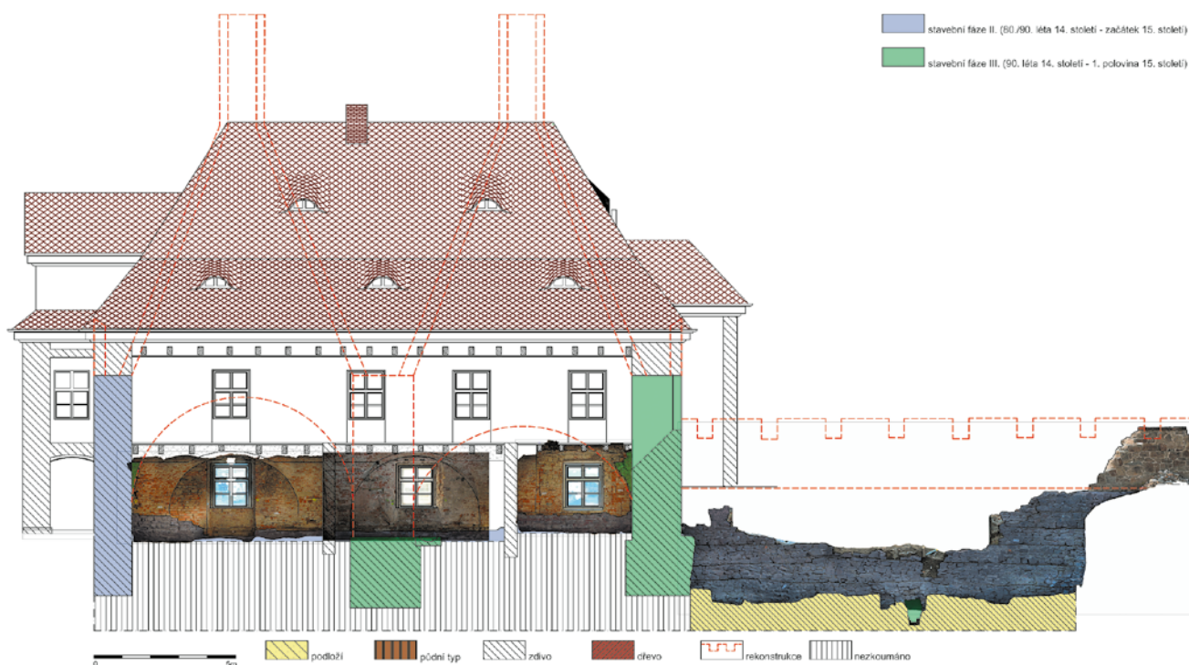
Obr. 33: Opava, Müllerův dům čp. 1, archeologický výzkum 2013, operativní průzkum a dokumentace 2016–2017. Podélný řez objektem s vyznačením hlavních nálezových situací z období středověku. Barevně vyznačeny dochované podpovrchové i nadzemní relikty spojovací hradby městského opevnění a hradu (v řezu) a městské parkánové hradby ze závěru 14. století (transparentní modrá), jižní obvodová zeď (v řezu) se základem pilíře dymníkových komínů a s výlevkou, a propust v parkánové hradbě z přelomu 14. a 15. století až první poloviny 15. století (transparentní zelená). Červenou čárkovanou linií rekonstrukce možné podoby hradních kuchyní s dvojicí dymníkových komínů a navazující průběh městské parkánové hradby (zaměření fasády M. Struhala, fotogrammetrie R. Kadlubiec, úpravy a celkové zpracování F. Kolář, 2021).
