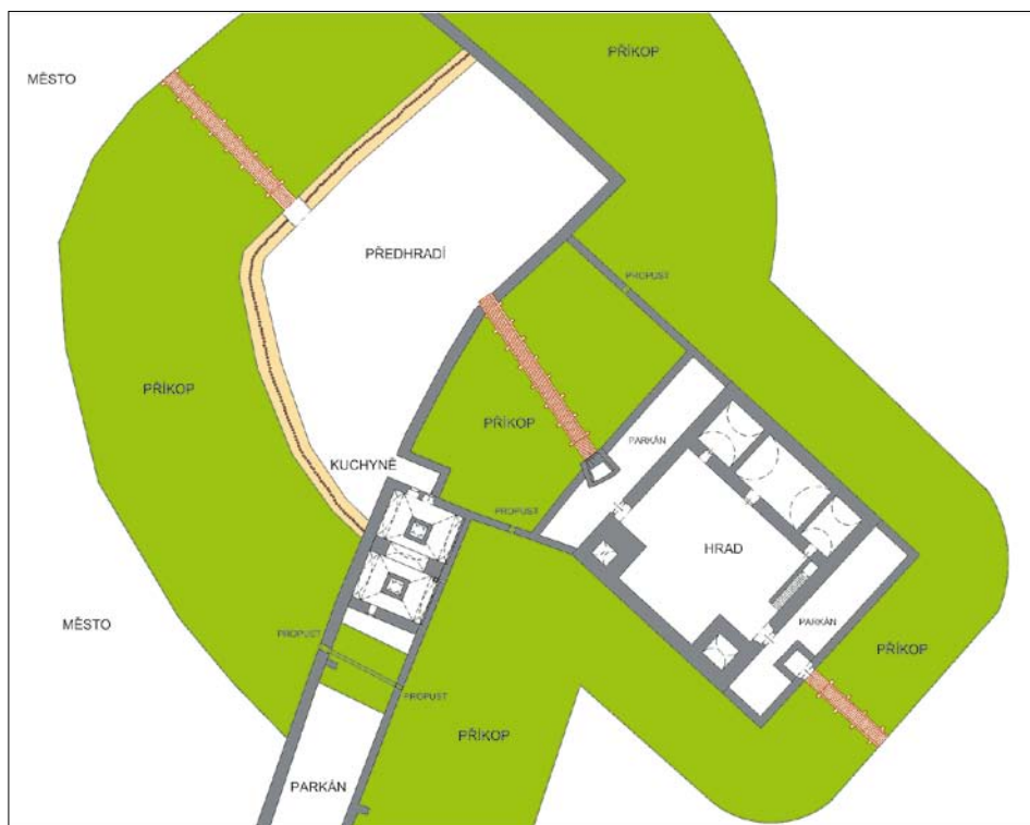
Obr. 18: Opava, areál někdejšího hradu a předhradí, rekonstrukce středověkých zděných konstrukcí hradu a Müllerova domu v úrovni 1. NP (tmavě šedě) a předpokládaný průběh příkopů ve fázi IV. (1. polovina 15. století) (celkové zpracování F. Kolář, 2021).
