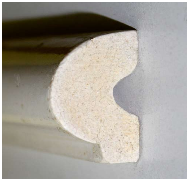
Obr. 48: Obrubka, užívaná k završení interiérového keramického obkladu stěn (Muzeum TGM v Rakovníku).
