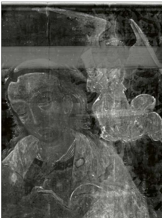
Obr. 4: Obraz korunované Panny Marie s Ježíškem z muzea v Telči – detail kontaktu prken desky vedoucí přes postavu pravého anděla (vpravo) a praskliny vedoucí středem desky (nalevo) na RTG snímku.
