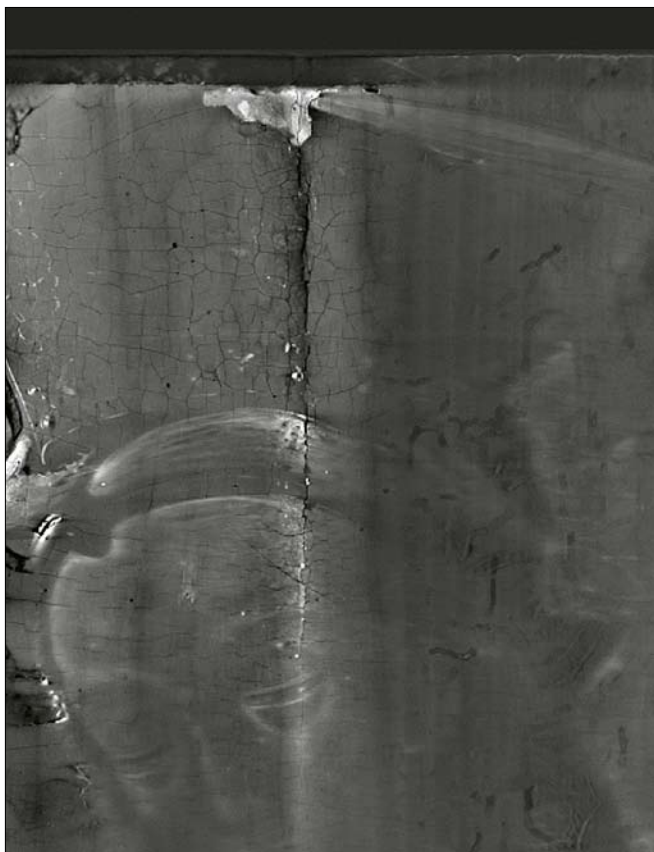
Obr. 7: Obraz korunované Panny Marie s Ježíškem z muzea v Telči – detail zatmeleného poškození malby u středové praskliny při Martíně koruně, CT model.
