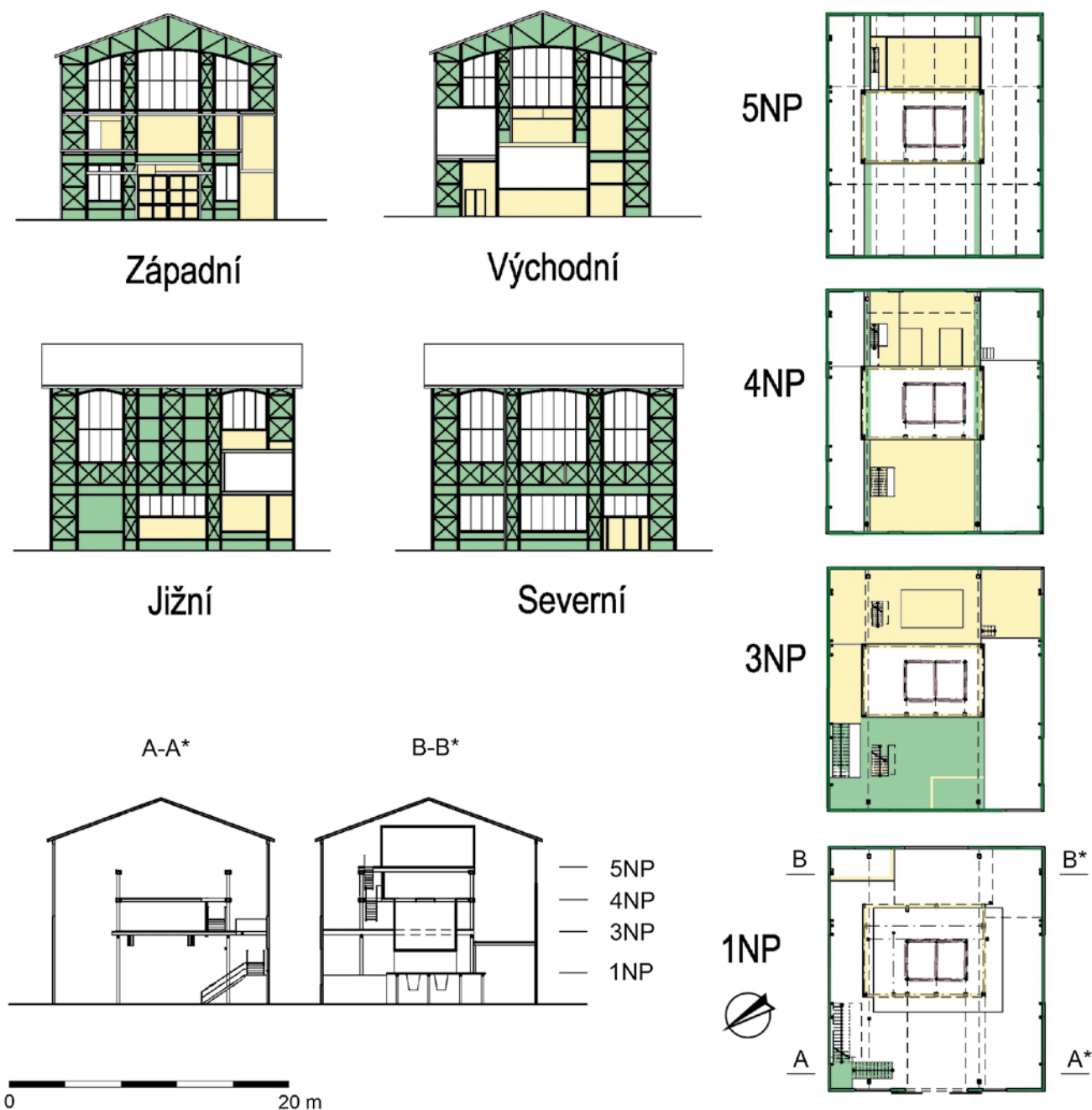
Obr. 28. Důl Gabriela, jámová budova těžní jámy č. I, vyhodnocení stavebního vývoje (schéma Marek Peška, 2022).
