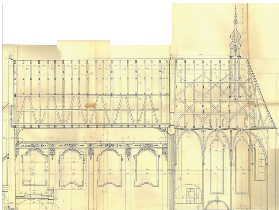
Obr. 2: Miličín, kostel Narození Panny Marie, zaměření kostela, podélný řez, výřez krovů (zaměření R. Zidek – V. Vejvodský – F. Skoda – J. Schmail(er?), 1946, archiv NPÚ ÚOP SČ Čech, inv. č. 178).
