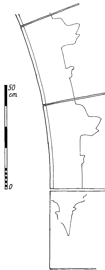
Obr. 7: Praha, dům č. p. 634/I. Stopy členění osekané rámcující lišty zrušeného gotického vstupního portálu. (Zaměření Jan Sommer, 1994.)
