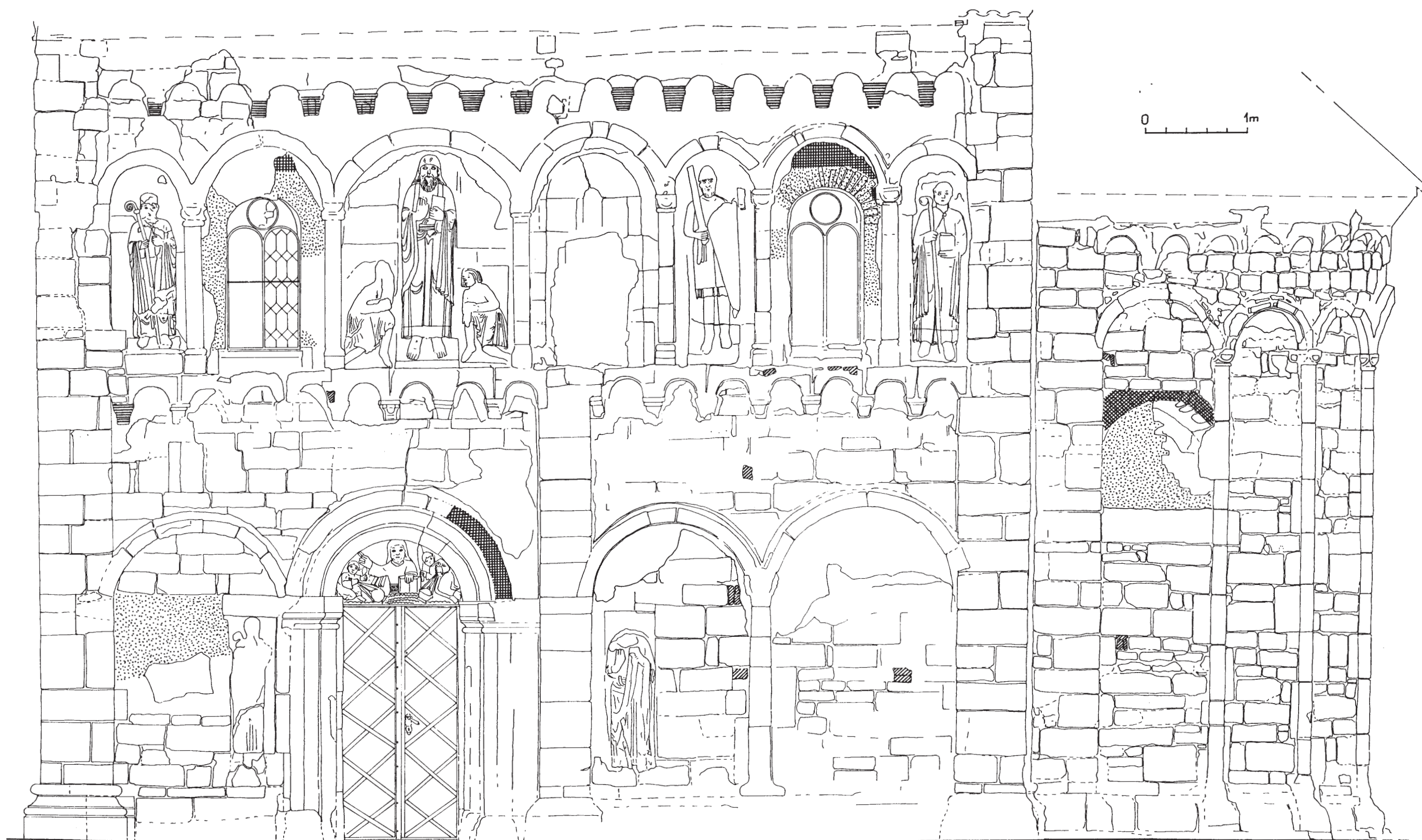
Obr. 36: Jakub, kostel sv. Jakuba. Jižní průčelí lodí. Rozbor barevnosti románského zdiva a architektonických článků. Tečkované žlutý pískovec, čárkované červený pískovec, neoznačen je šedý pískovec, omítnuté plochy a architektonické články (s použitím fotogrametrického zaměření firmy AGM na základě podkladu zpracovaného J. Žížkou zakreslil P. Kroupa, 1997).
