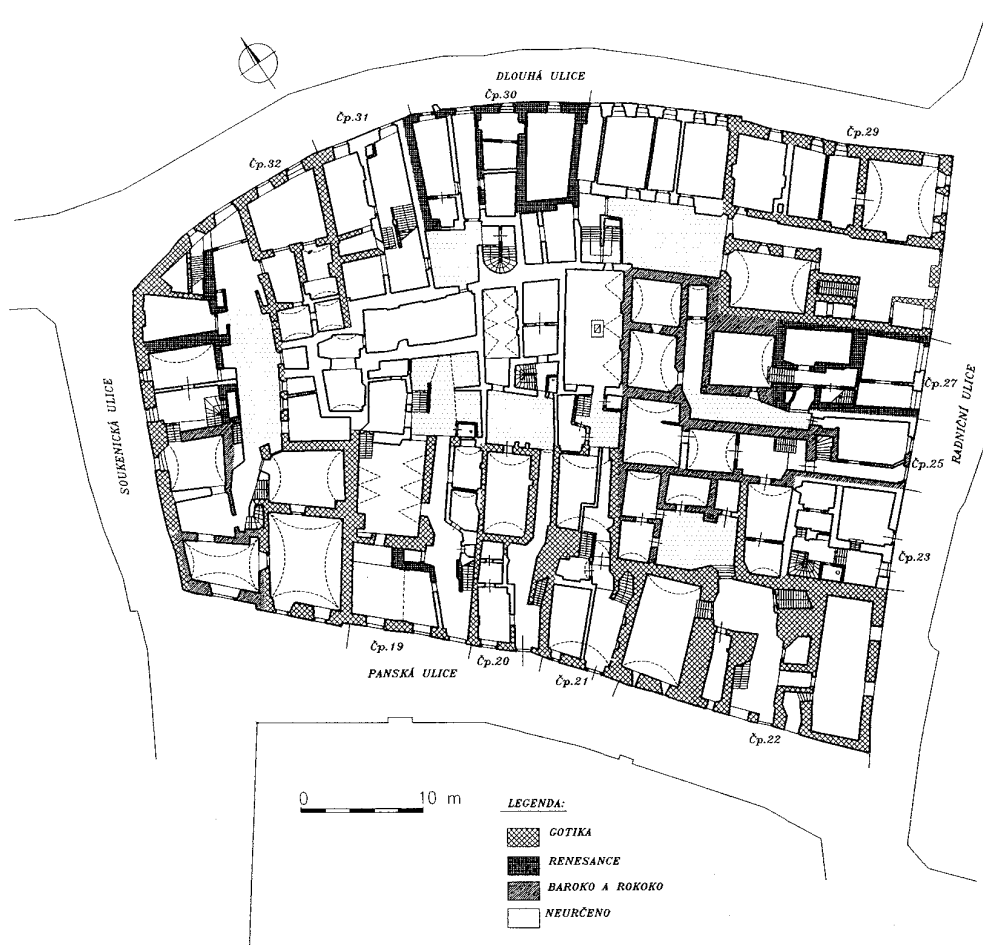
Obr. 4: Český Krumlov. Púdorysy domů sledovaného bloku v centru města v úrovni přízemí (podle mapy A. Beneše a kolektivu). Na plánu je vyznačeno datování jednotlivých částí zdiva a dnes neexistující zástavba v prostoru vnitřního dvora a dvorku domu čp. 22.
