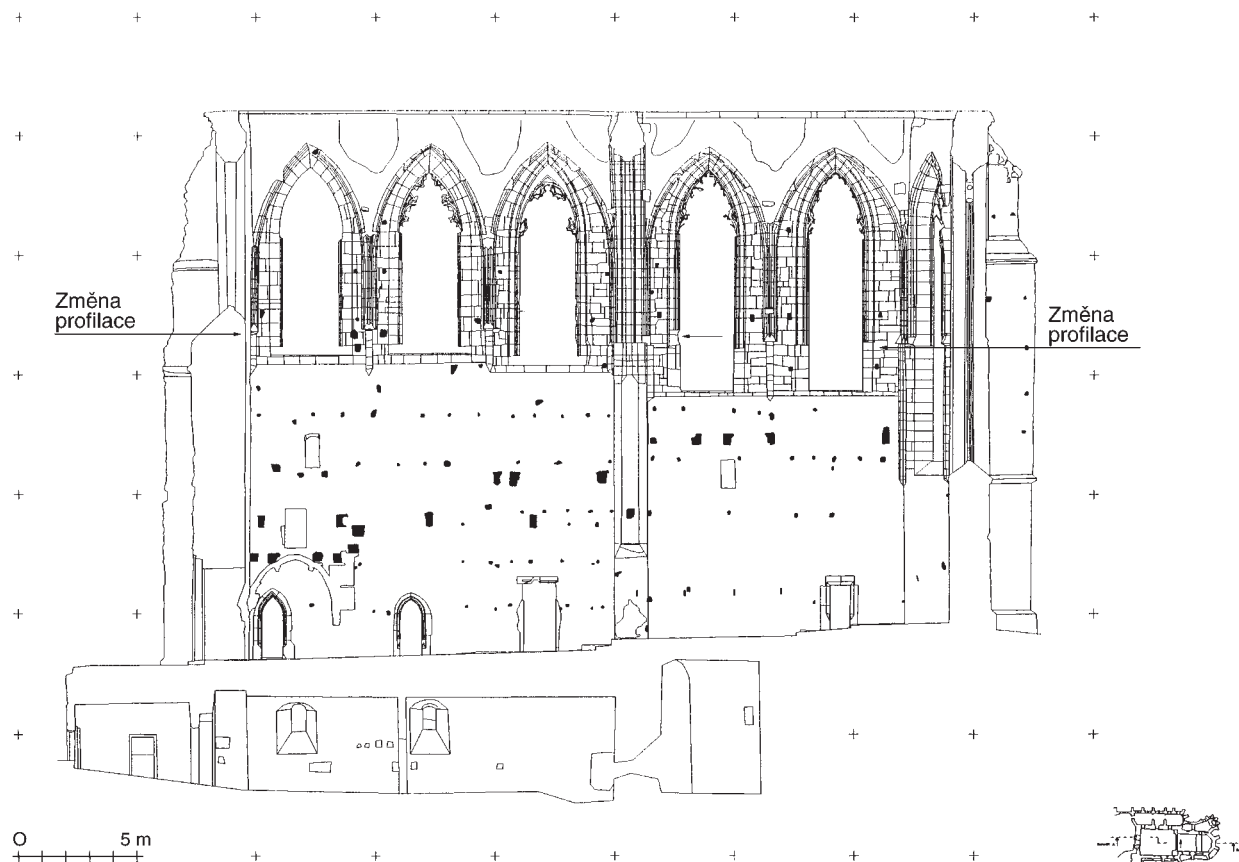
Obr. 18: Ojvín, kostelní ruína. Fotogrammetrický snímek. Pohled na severní vnitřní stěnu lodi, chóru a spodního zaklenutého prostoru. Šipka vyznačuje změnu profilace a materiálu mezi dvěma stavebními úseky (Messbildstelle Dresden, 1993).
