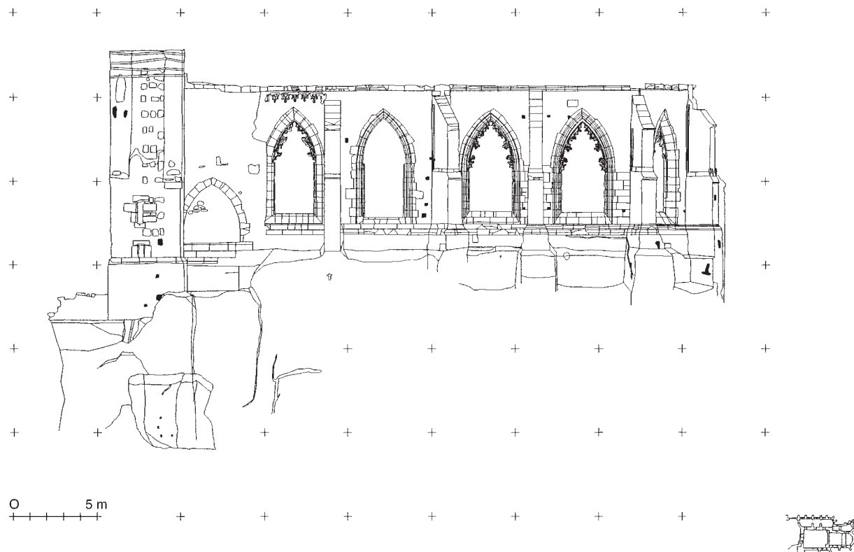
Obr. 16: Ojvin, kostelní ruína. Fotogrammetrický snímek. Pohled na jižní vnější stranu s torzem věže (Messbildstelle Dresden, 1993).
