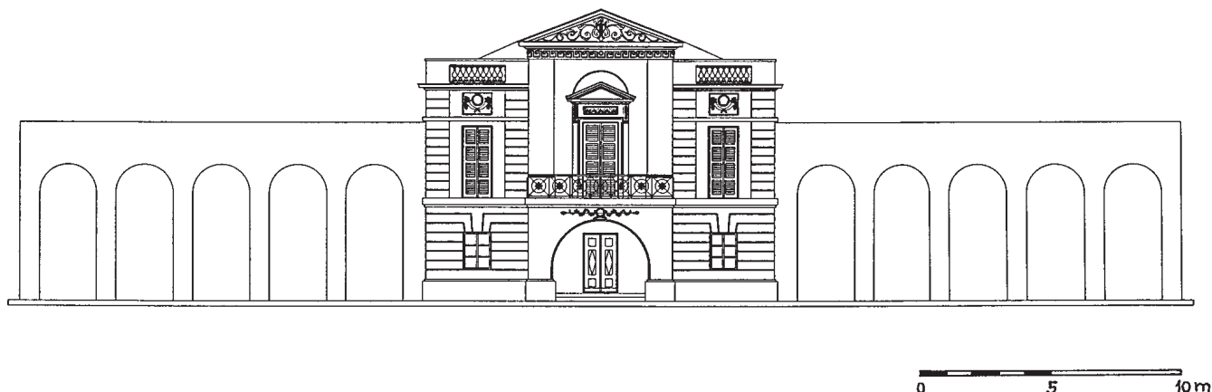
Obr. 6: Rybníční zámek. Hypotetická rekonstrukce stavu s arkádovými křídly (do zaměření firmy ARCH 21, s. r. o. zakreslila M. Molišová).
