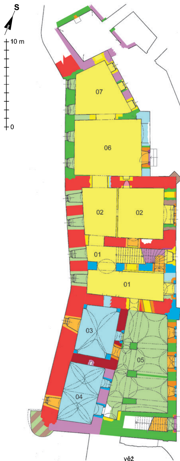
Obr. 6: Bečov nad Teplou, hrad, tzv. Pluhovské domy, stavební vývoj, přízemí (autorova analýza s použitím plánového podkladu J. Čepeláka).
