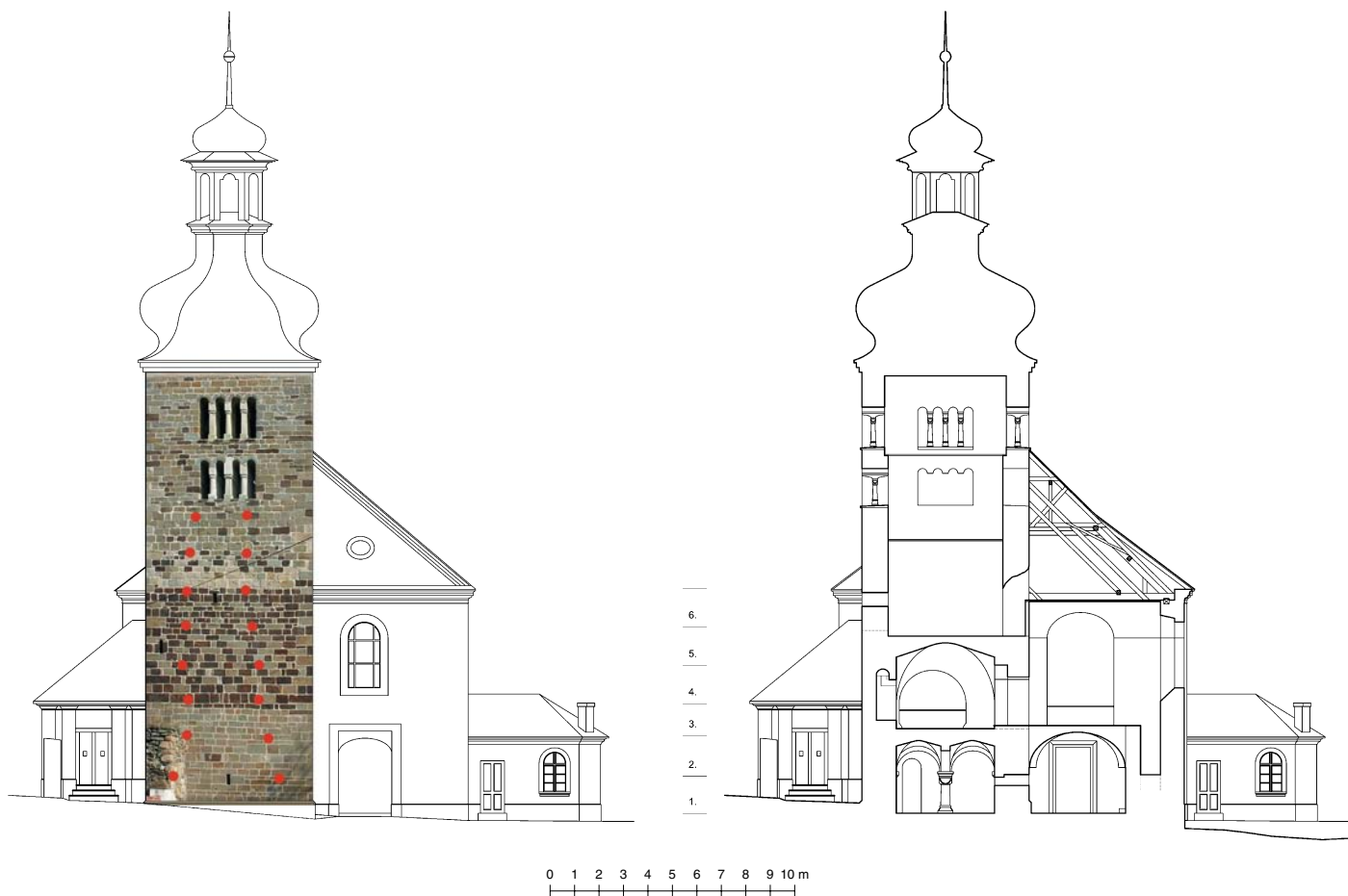
Obr. 14: Svojšín, kostel sv. Petra a Pavla. Pohled na věž s vyznačenými otvory pro lešení. Z nich jsou odvozeny vrstvy zachycující průběh prvních dvou etap výstavby věže: vrstvy 1–3 (ve světlém pískovci), dokončeno podvěží a stavba dovedena nad podlahu tribuny; vrstvy 4–6 (v červenohnědé arkóze), dokončena věžní část tribuny a schodiště v tloušťce zdi vyvedeno nad rub její klenby. Poté byla stavba přerušena. V následujících dvou vrstvách světlého pískovce bylo dosaženo úrovně pod parapetem spodních sdružených oken. Okenní zóna byla vyzděna pomocí vykonzolovaného lešení. Řez umožňuje sledovat postup stavby ve vztahu k interiéru věže (zaměření a kresba M. Falta).
