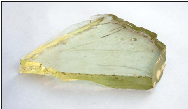
Obr. 5: Vila Tugendhat, největší fragment skla mírně nažloutlé barvy a tloušťky 9,8 mm objevený ve výkopu u ziminí zahrady.
