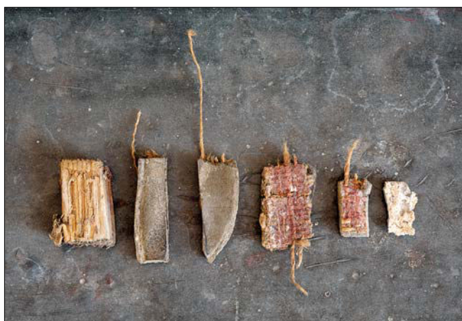
Obr. 2: Vila Tugendhat: a – spojení segmentů opláštění ocelových nosných sloupů v hlavním obytném prostoru (2. NP), vlevo nahoře hlava nýtu, vpravo distanční dřevěný špalík s fragmentem původního linolea značky DLW; b – fragmenty distančního dřevěného špalíku (vlevo) a původního linolea značky DLW, které se dochovaly pod opláštěním ocelových nosných sloupů v hlavním obytném prostoru (2. NP).
