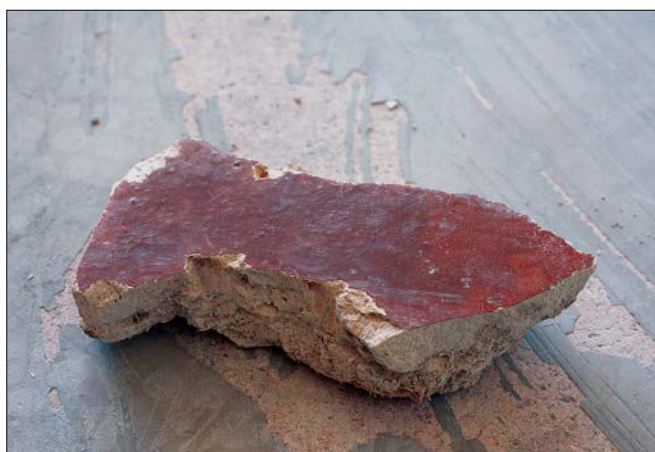
Obr. 3: Vila Tugendhat: a – řez vrstvou Sorelova cementu (vlevo), který se dochoval pod onyxovou přičkou v hlavním obytném prostoru (2. NP), vpravo ocelový nosný prvek vynášející tuto přičku; b – fragment Sorelova cementu s červeným tvrdým povrchem, který byl vyjmut ze zdiva za knihovnou v hlavním obytném prostoru (2. NP).
