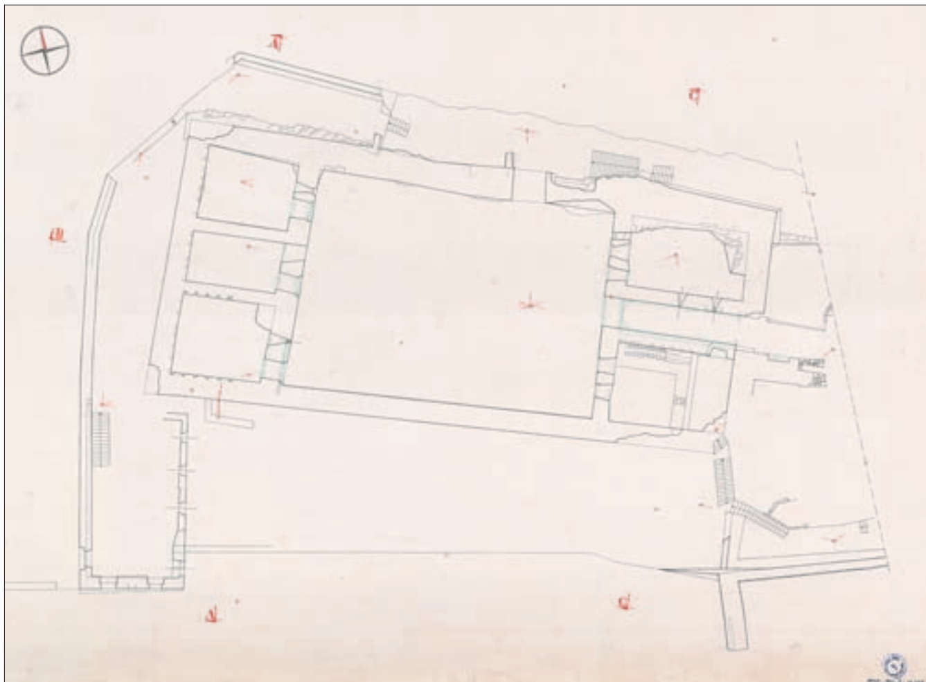
Obr. 5: Dívčí Kámen, hrad. Palácové jádro obklopené ze tří stran parkánem, v jehož jihozápadním koutu se nachází obytná stavba (zaměření a kresba J. Houžvíc a kol., 1962, 1964; měřítko originálu 1:100, měřítko reprodukce 1:500).
