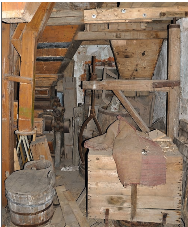
Obr. 29: Dětřichovec, mlýn čp. 30, mlýnice č. 2.01 – v popředí jeřáb na zvedání mlecích kamenů (tzv. graník), za ním špičovací složení.
