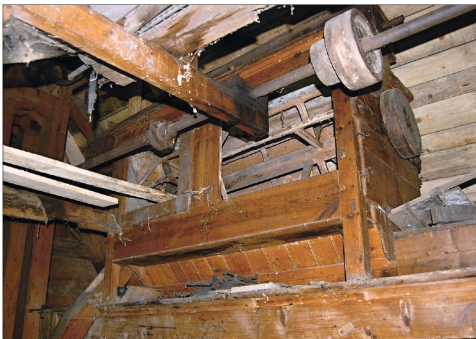
Obr. 34: Dětrichovec, mlýn čp. 30, podkroví č. 3.01 – předvysévač usazený na skříní hranolového vysévače.
