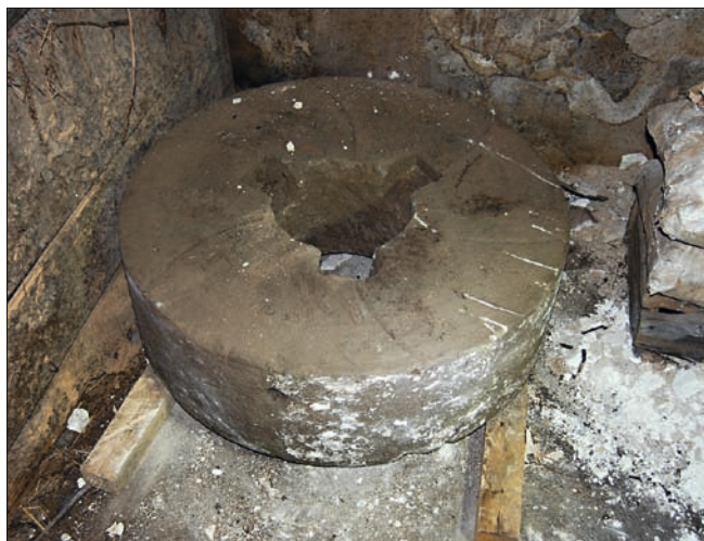
Obr. 30: Dětřichovec, mlýn čp. 30, mlecí kámen (běhoun), deponovaný v hospodářském objektu.
