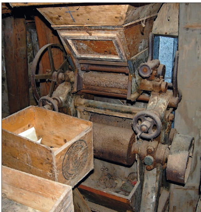
Obr. 31: Dětřichovec, mlýn čp. 30, mlýnice č. 2.01 – válcová mlecí stolice, čelní pohled.
