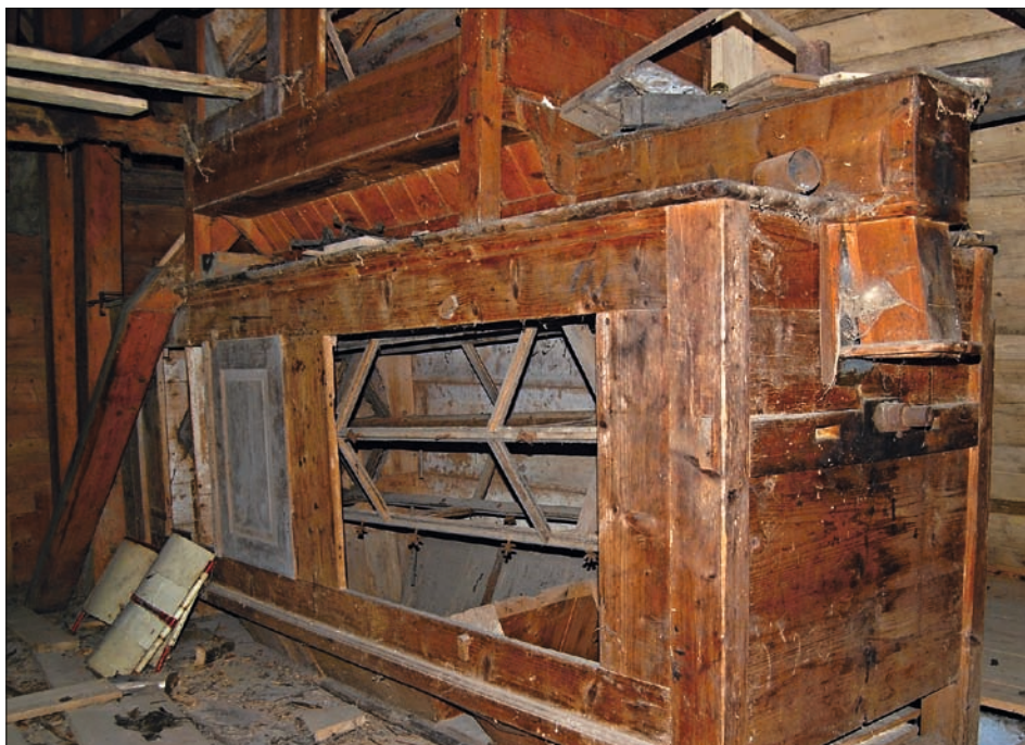
Obr. 33: Dětrichovec, mlýn čp. 30, podkroví č. 3.01 – hranolový vysévač.
