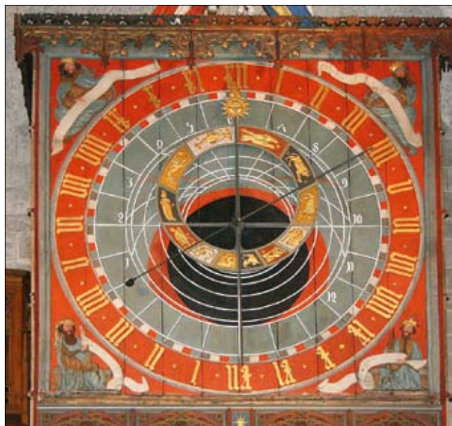
Obr. 25: Podoba zrestaurované astrolábové desky orloje v Lundu (1425). Na rozdíl od astrolábové desky Pražského orloje zde, stejně jako u mnoha severovýchodních orlojů, probíhá obzor přes vnitřní středový kruh obratníku Kozoroha. Uprostřed astrolábu uvnitř kruhu o nejmenším průměru (foto https://commons.wikimedia.org/wiki/File:Lund_astron_uhr_032.JPG ).
