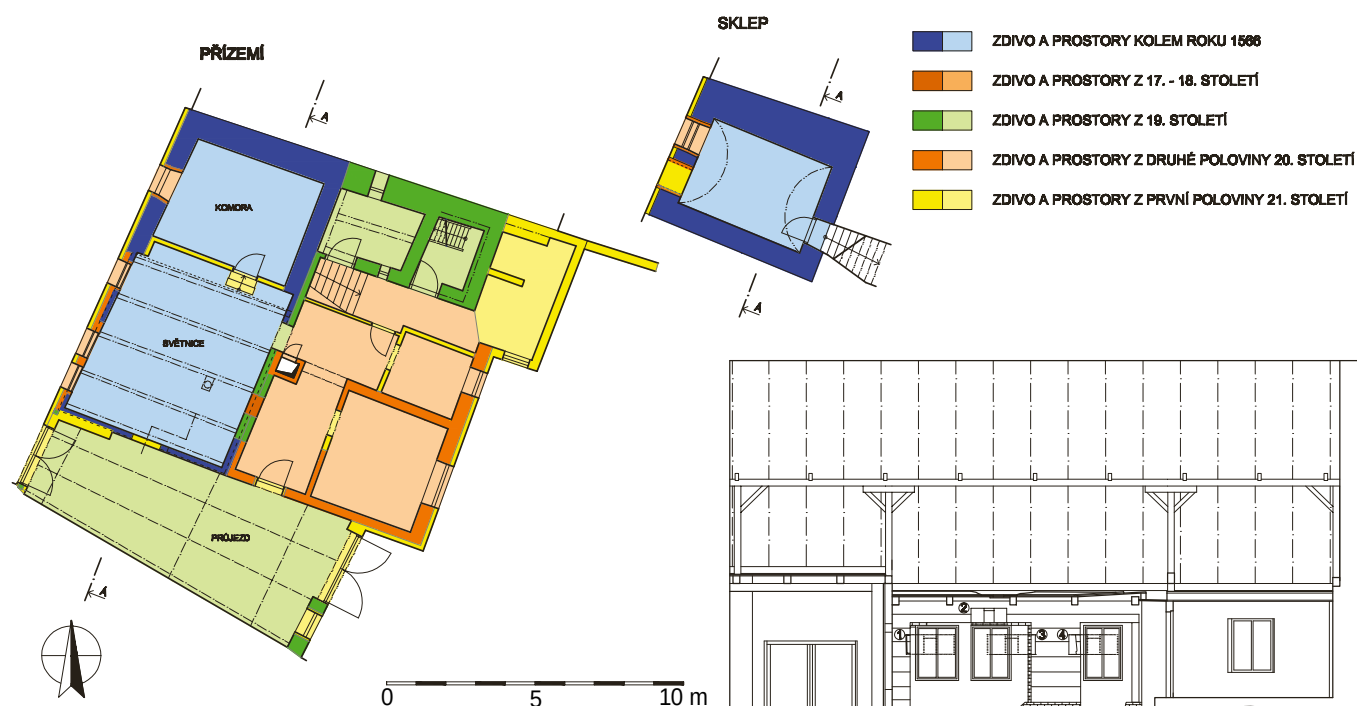
Obr. 25: Vyšší Brod, dům čp. 24, stavebně historické vyhodnocení vývoje domu (zaměření a zákres V. Babická, vyhodnocení D. Šnejd).
